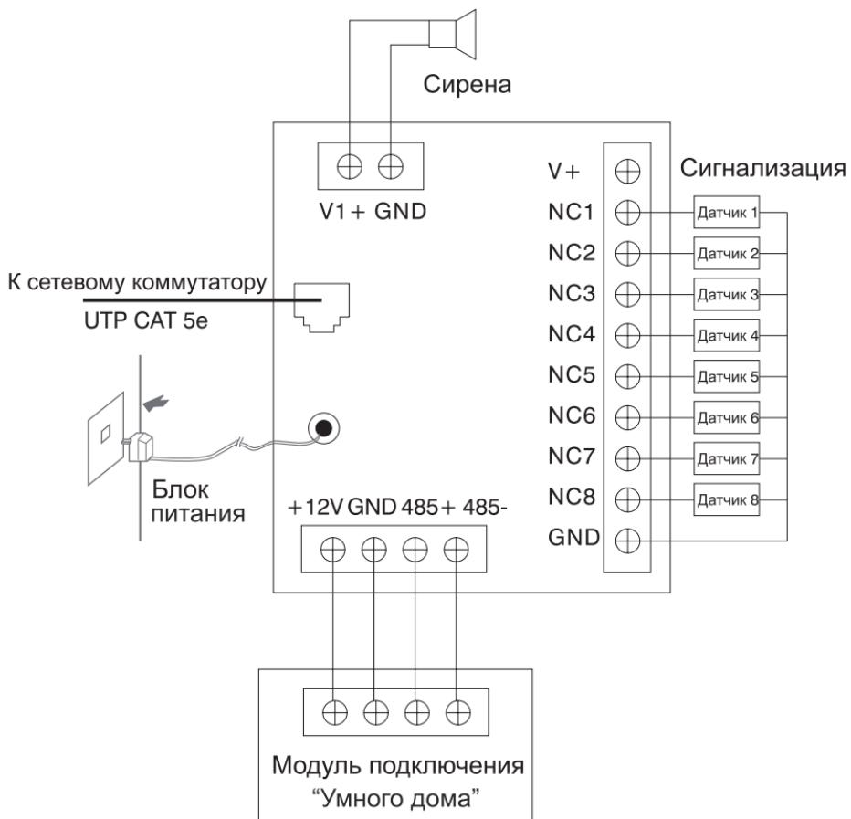
Подключение разъемов на задней стенке внутреннего монитора.
